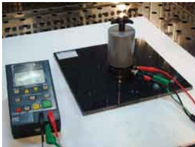
Figura 3. Medición de la resistencia superficial en un pavimento.
