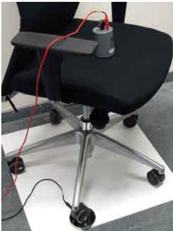
Figura 2. Ensayo de sillas. Medición de la resistencia eléctrica entre el asiento y una rueda.
