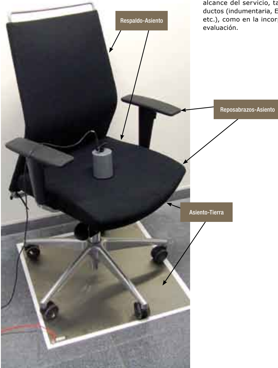
Figura 4. Ejemplo de algunas mediciones de resistencia entre diferentes partes de la silla. En la imagen se está realizando la medición de la resistencia eléctrica entre el asiento y tierra.
