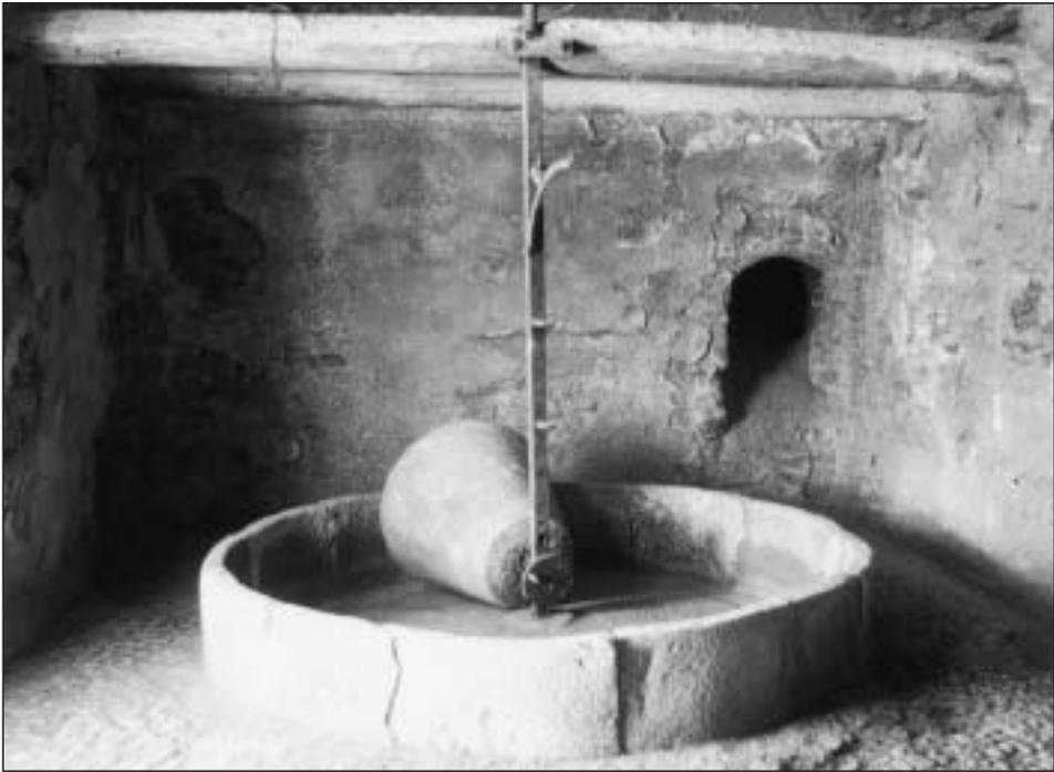
Molino del trujal del palacio de Marichalar, en San Adrián. Esta instalación se complementa con una prensa manual accionada por un torno o malacate
