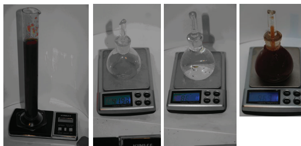
Figura 8. Medida de la densidad de la mermelada, de modo sencillo, y usando el picnómetro
