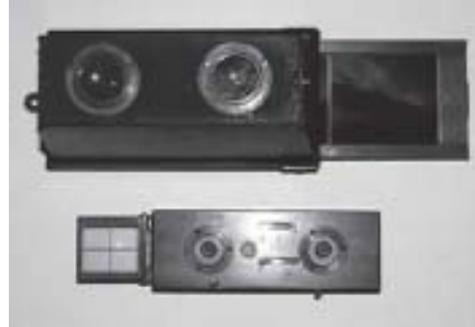
Para obtener una fotografía estereoscópica se emplea una cámara con dos objetivos separados por la distancia interpupilar o bien se usa una cámara convencional de un sólo objetivo desplazándola unos 65 mm. para hacer la segunda toma. Naturalmente, el sujeto no debe moverse entre las dos tomas, por lo que sólo sirve para fotografiar objetos inmóviles.
