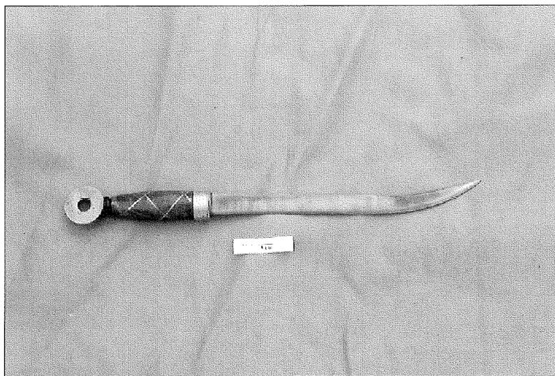
Lámina 12.- Cuchillo en acero de Damasco ( $Fe-1,8C$ ) forjado en caliente según las variables definidas en las conclusiones de esta investigación.
