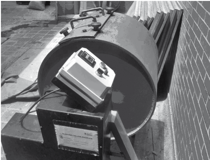
Figura 1. Máquina de ensayo de los Ángeles, Universidad Militar Nueva Granada
