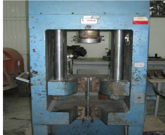
Figura 11 Ensayo de tensión de una varilla de acero
