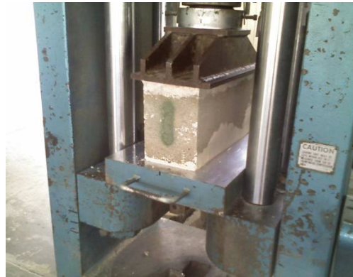
Figura 7 Bloque colocado en la máquina de prueba
