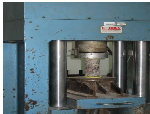
Figura 9 Prueba de compresión de un corazón, usando la máquina universal
