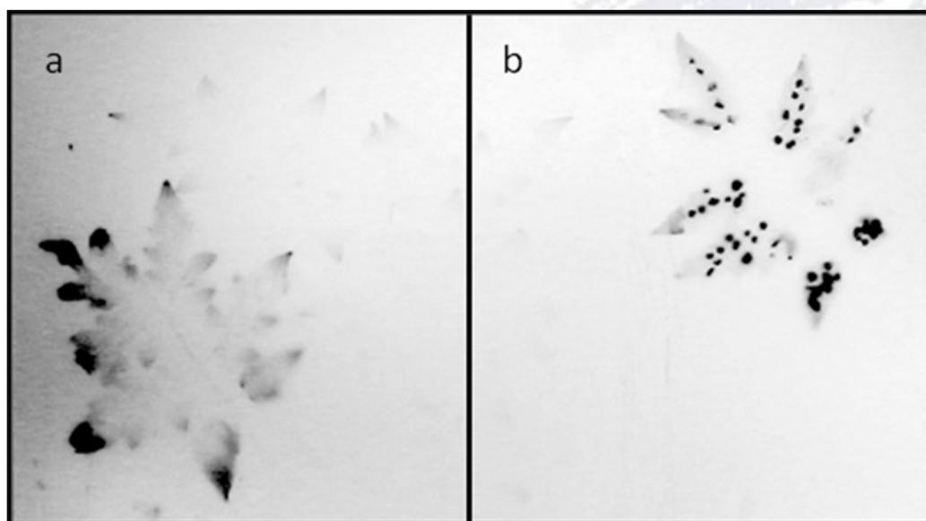
**Fig. 2.** Radiografía a los 6 después de la aplicación del  $^{14}\text{C}$ -Imidacloprid/INEX-A vía foliar en tomate (*Lycopersicum esculentum* L.). a) Con INEX-A/ $^{14}\text{C}$ -Imidacloprid; b) Sin INEX-A/ $^{14}\text{C}$ -Imidacloprid.
