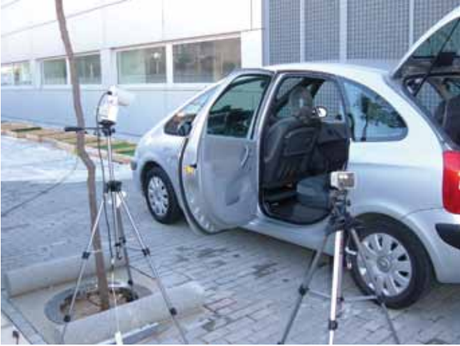
Figura 1. Escenario de pruebas y sistema de fotogrametría.
