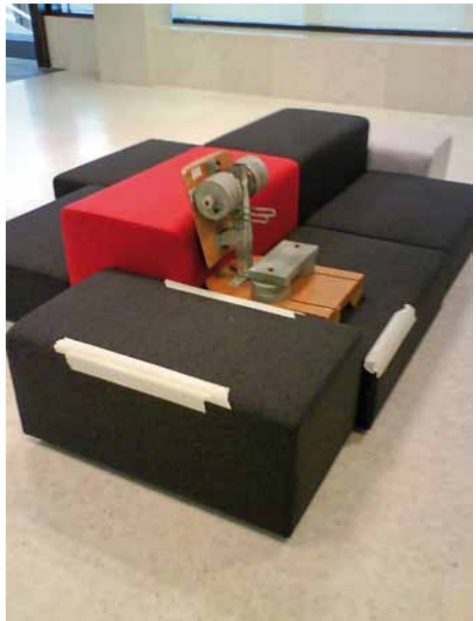
Figura 2. Ensayo de adecuación dimensional en un sofá.
