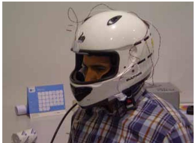
Figura 3. Instrumentación del casco con sensores.
