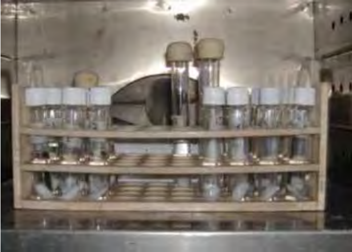
FIGURA 3. Muestras de polímero en el horno durante el ensayo de degradación hidrolítica. Fuente: Solís, y Betancur, C. Tesis de Grado. Universidad del Valle. 2007
