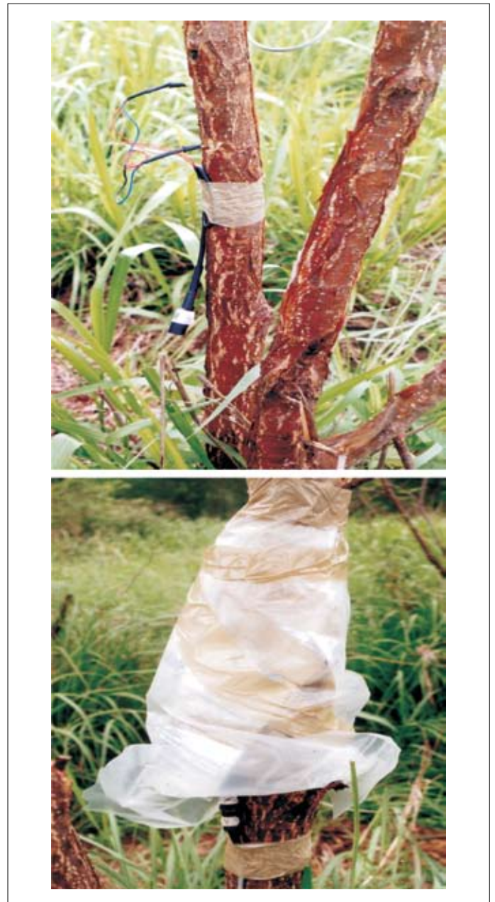
Figura 1. Instalación de equipo de medición de flujo de savia en árboles de Diphysa robiniooides en Cañas, Costa Rica
