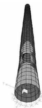
Figura 3. Esfuerzos circunferenciales debidos al gradiente térmico en el fuste, kg/cm 2 .
