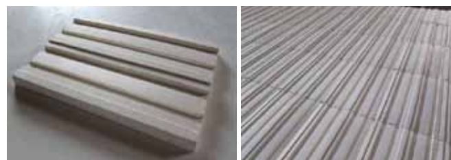
Figura 14. Prototipo de baldosa extruida para mejora de las propiedades acústicas de salas.
