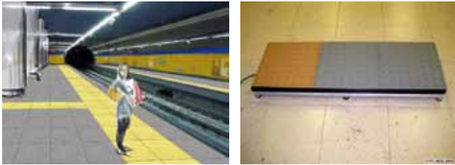
Figura 15. Integración de prototipo de baldosa cerámica con capacidad de vibración.
