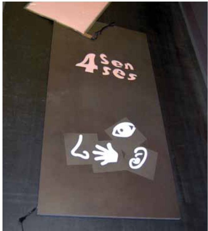
Figura 16. Baldosas con recubrimiento de microesferas de vidrio para optimizar la proyección sobre cerámica.
