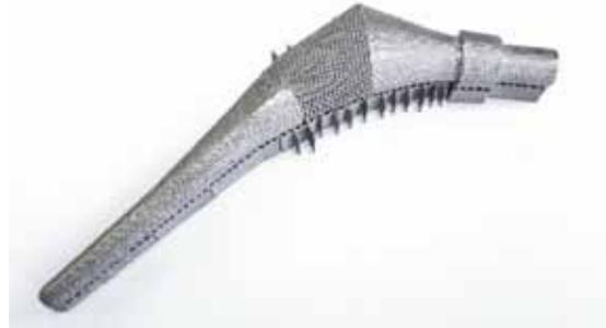
Figura 3. Ejemplo de vástago de prótesis de cadera obtenido mediante tecnología EBM. Estado previo a la eliminación de los puntos de apoyo de fabricación y pulido.
