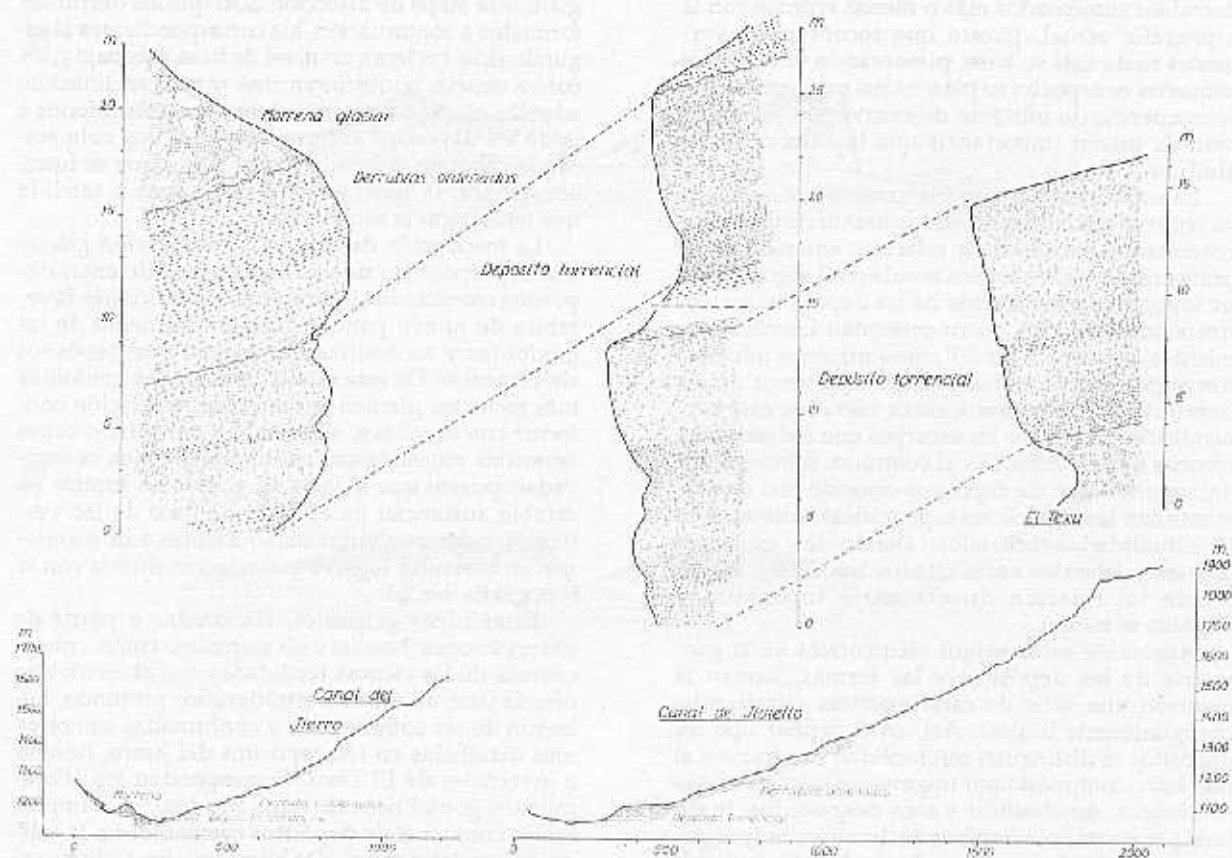
Fig. 4 Cortes estratigráficos en los depósitos cementados de las canales del Jierro y Jidiello y de las invernales de El Teju. Aparece señalada la correlación lateral de las diferentes facies. Para mayor detalle, léase la descripción en el texto.
