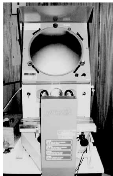
Figura 1. Proyector de perfiles Prazis® referencia PG360HE
