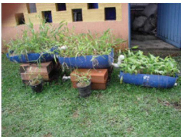
Foto 3. Unidades del sistema piloto del humedal artificial
