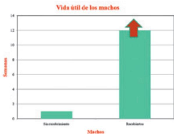
**Figura 7.** Incremento de vida útil en semanas de machos recubiertos durante proceso de inyección de PEAD. La flecha indica que al momento de corte de la toma de datos, los machos continuaban trabajando sin presentar el problema del polvillo negro generado por el proceso de desgaste.
