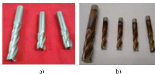
**Figura 9.** a) Fresas antes del proceso de recubrimiento. b) Fresas recubiertas con recubrimiento multicapas de  $B_4C/BCN/c-BN$
