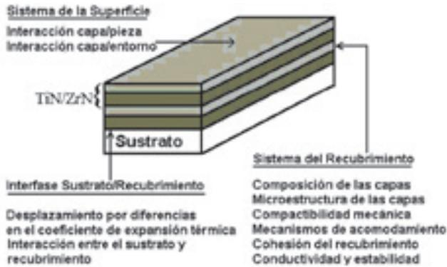
**Figura 2.** Esquema de un sistema sustrato/recubrimiento multicapa.
