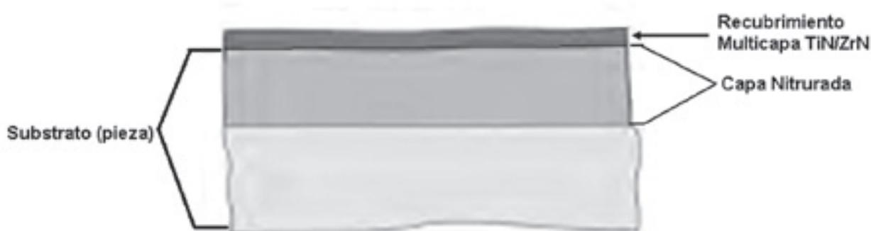
**Figura 8.** Recubrimiento *dúplex no-in situ* generado en los machos del molde para inyección de polipropileno.
