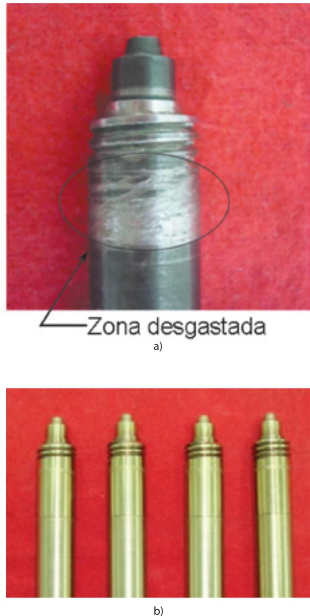
**Figura 6.** a) Macho nitrurado que indica zona de desgaste tras proceso de inyección. b) Machos nitrurados recubiertos con sistema multicapa TiN/ZrN.
