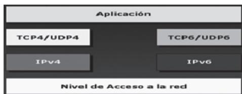
Figura 3. Modelo doble pila de protocolos.
