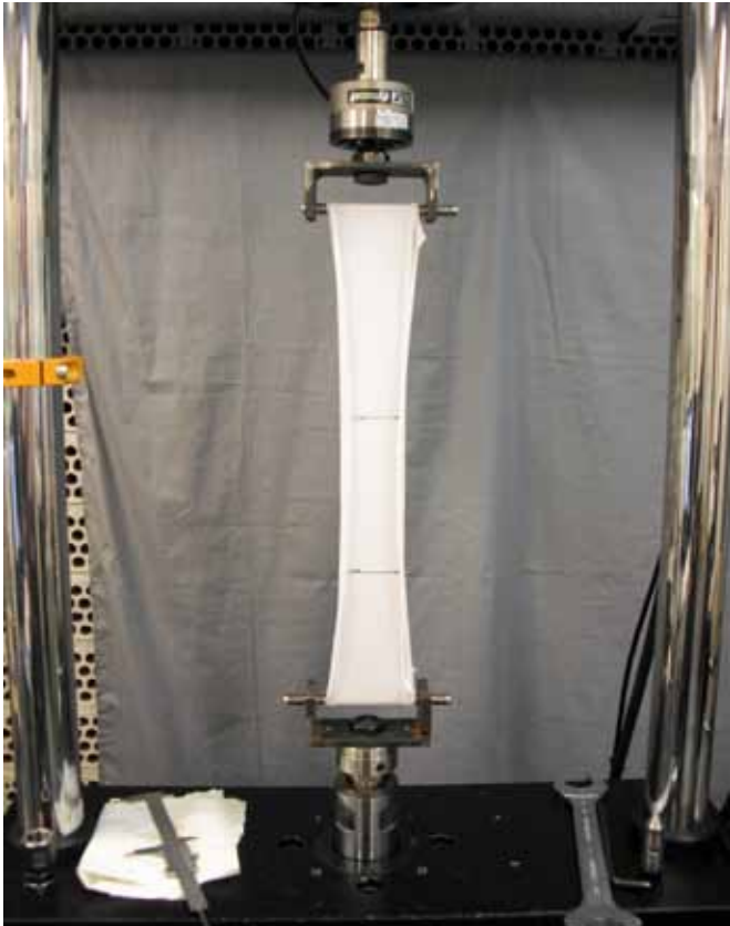
Figura 2. Ensayo de elasticidad del tejido.
