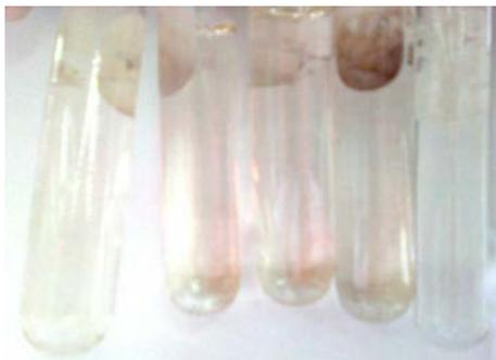
Fig. 3. Muestras después del tratamiento Fenton con 500 ppm de catalizador
