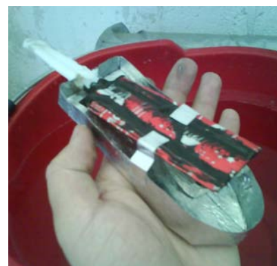
FIGURA 8. Imagen de una lanchita pof pof que funciona a base de vapor.
