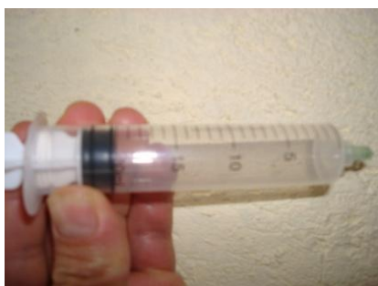
FIGURA 2. Con el aire encerrado en una jeringa puede obtenerse la ley de Boyle.
