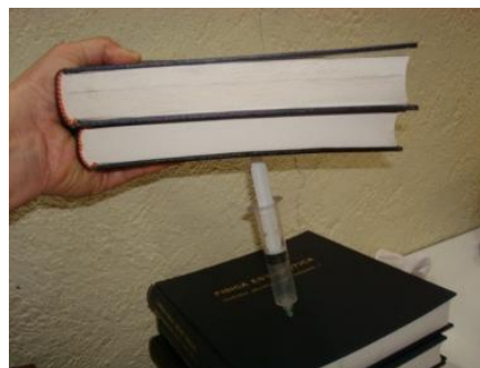
FIGURA 3. Variación de la presión y el volumen usando varios pesos (libros).
