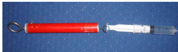
FIGURA 4. Con un dinamómetro es posible medir la fuerza de fricción entre émbolo y las paredes de la jeringa.
