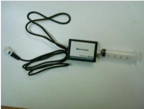
FIGURA 8. El sensor de presión tiene integrada una jeringa, como se muestra en la figura.
