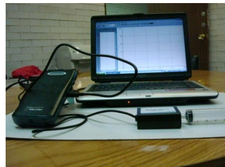
FIGURA 7. Dispositivos para medir de manera automatizada presión y volumen dentro de la jeringa.
