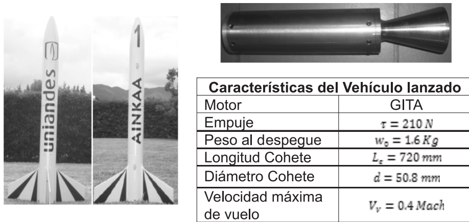
Figura 3. Características del Cohete Ainkaa 1 y su motor propulsor GITA
