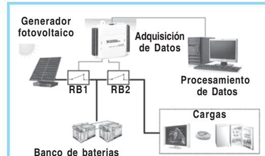
Figura 2. Sistema fotovoltaico implementado. Tomado de [7].
