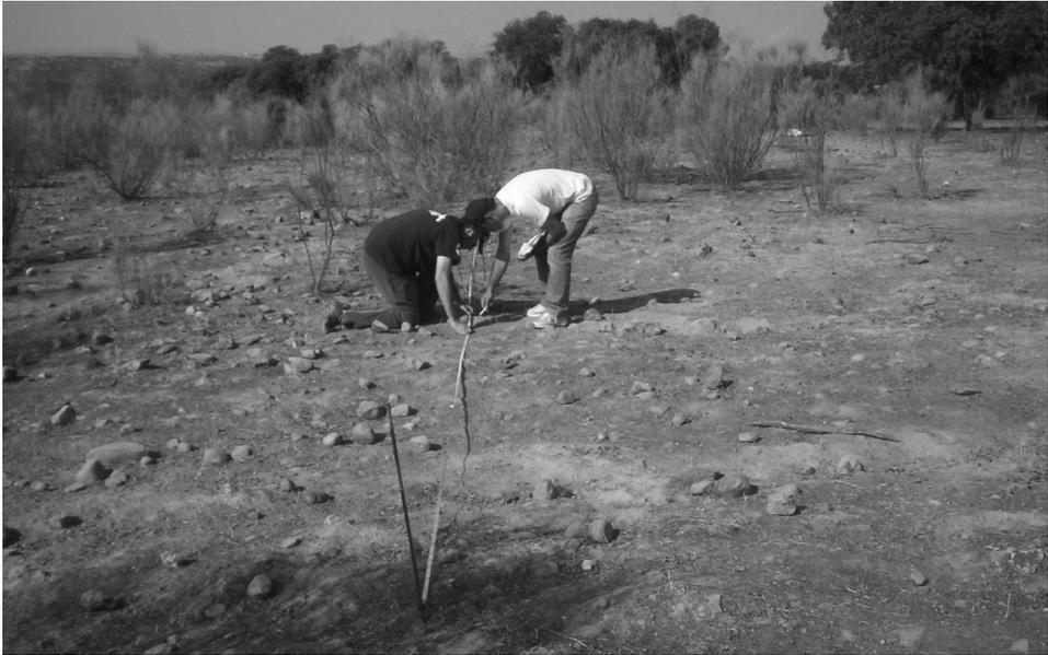
Figura 4. Fotografía tomadas en campo para ser tratada posteriormente en gabinete de la cobertura superficial del suelo usando un cuadrado de 0,25 m<sup>2</sup> de superficie.
