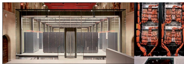
Figura 2. La computadora Mare Nostrum que permite realizar las simulaciones teóricas que se describen en este artículo. El detalle muestra las conexiones entre los diversos blades que constituyen el core computacional. 9
