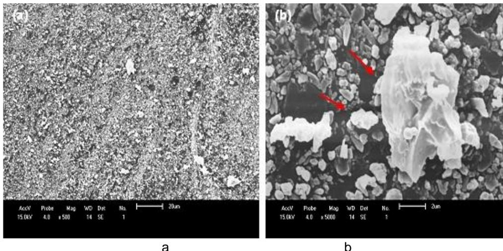
**Fig. 4. Fotomicrografías obtenidas por MEV de la sección transversal del compuesto de RTV SR con 5% de nanosílice. (a) Aumentado 500 veces, (b) Aumentado 5 000 veces.**
