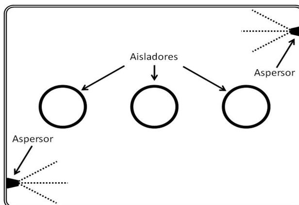
**Fig. 3. Esquema superior de la cámara de niebla.**
