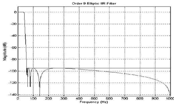
Fig.12. Respuesta de magnitud (dB) en función de la frecuencia (Hz) del filtro Elíptico IIR.
