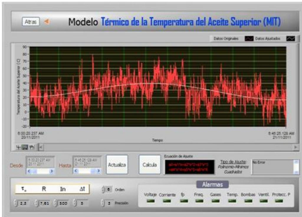
Fig. 16. Ventana visualizando la temperatura del aceite superior mediante el cálculo del MIT.
