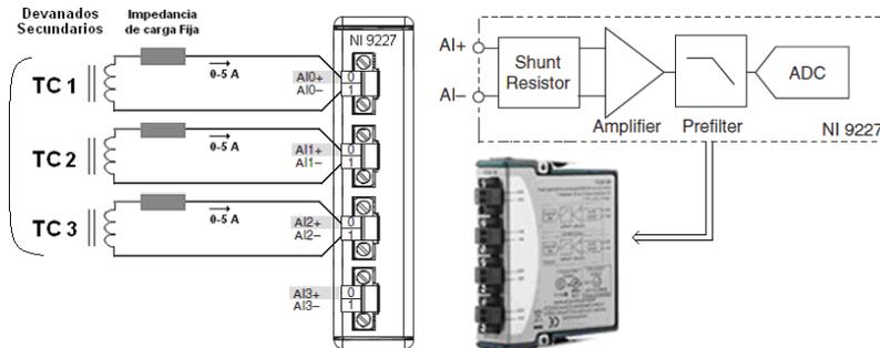
**Fig. 4. Diagrama de conexión eléctrica entre los TC y módulo NI 9227.**
