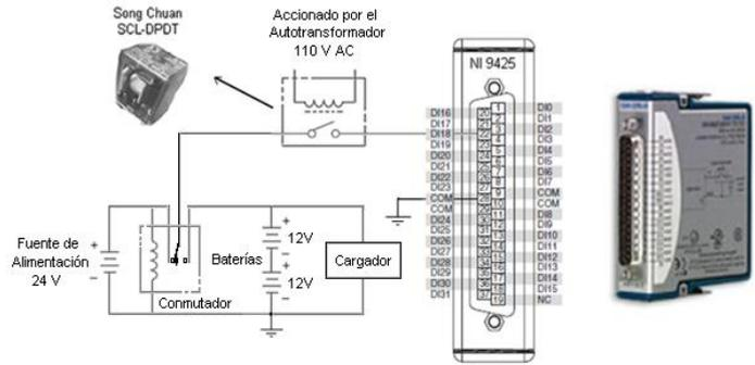
Fig. 7. Diagrama de conexión eléctrica entre un relé y un canal del módulo NI 9425.
