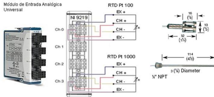
Fig. 5. Diagrama de conexión eléctrica entre dos RTD y un módulo NI 9219.
