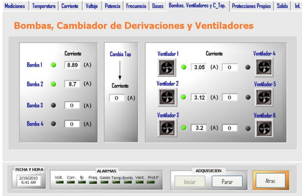
Fig. 15. Ventana visualizando es estado y la corriente de consumo de las bombas, los ventiladores y el cambia derivaciones del AT.
