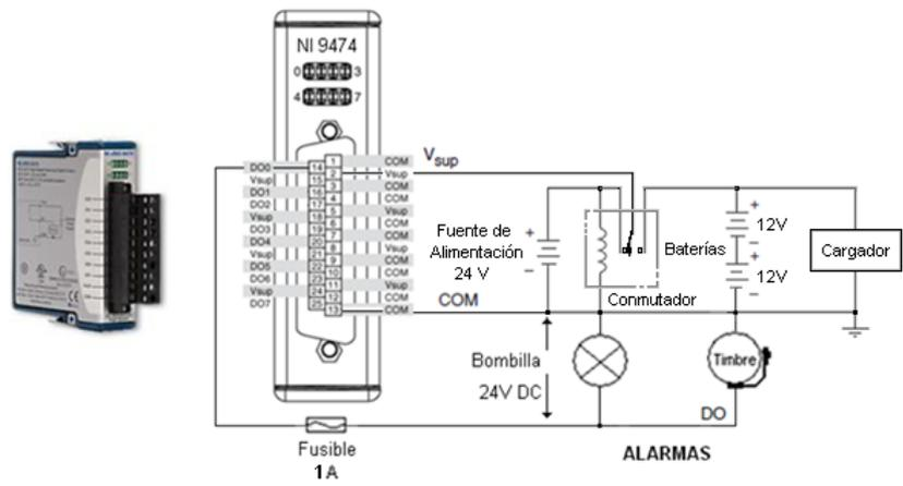
Fig. 8. Diagrama de conexión eléctrica entre alarma externa y módulo NI 9474.
