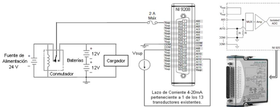
Fig. 6. Diagrama de conexión eléctrica entre un transductor con salida 4-20mA y el módulo NI 9208.
