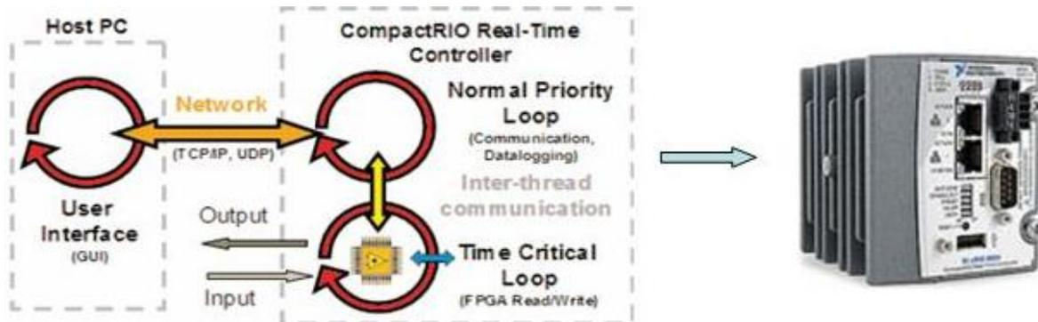
Fig.10. Controlador Embebido en Tiempo Real NI cRIO-9025.
