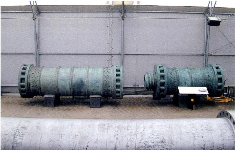
Fig. 2. El cañón de los Dardanelos, de 1464, con sus dos partes desenroscadas.
