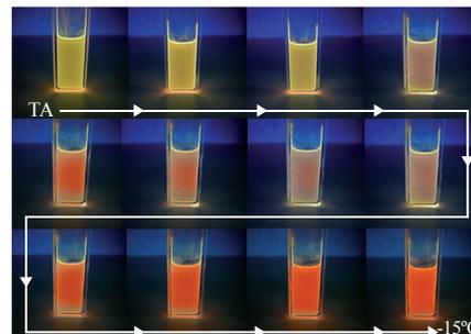
**Figura 20.** Cambio en el color de fluorescencia para el ditiénofosfol dendrítico A (ver Figura 19) durante la transición disolución  $\rightarrow$  gel desde temperatura ambiente (TA) hasta  $-15\text{ }^{\circ}\text{C}$ .
