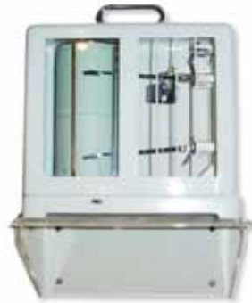
Termohigrómetro: equipo usado para medir la temperatura y la humedad relativa
