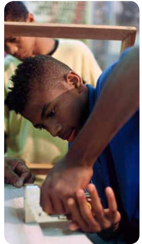
Preparación del bastidor. Tensado de la maya de nylon
