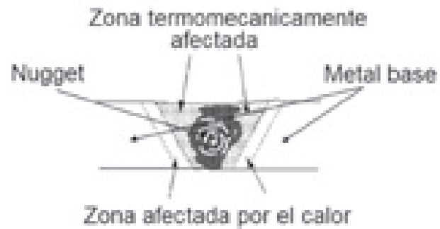
Figura 2. Zonas microestructurales generadas por el proceso.
