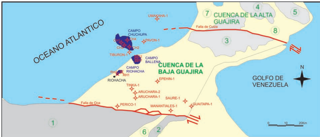
FIGURA 1. Mapa de la Península de la Guajira mostrando los rasgos fisiográficos y tectónicos que caracterizan y delimitan la Subcuenca de la Baja Guajira. 1) Sierra Nevada de Santa Marta, 2) Serranía de Perija, 3) Serranía de Cosinas, 4) Serranía de Jarara, 5) Serranía de Macuira, 6) Cuenca de Cesar-Ranchería, 7) Subcuenca de Portete y 8) Subcuenca de Cocinetas. Modificada de Rubio et al. (1998).
