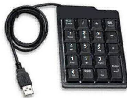
Figura 3. Imagen de un mini teclado numérico con conexión para puerto USB. La función de estos números es equivalente a la de los mostrados en la pantalla del programa por lo que al presionar un número, de este teclado, se iniciará el registro de la conducta correspondiente.
