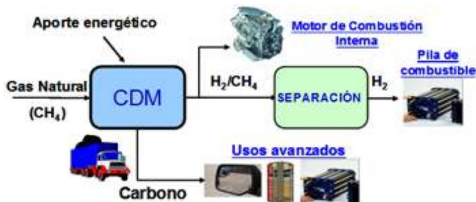
Figura 1. Esquema de la DCM
