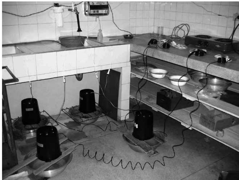
Figura 8. Instalación de calibración de pluviógrafos con suministro constante de caudal, a través de equipo de venoclis.
