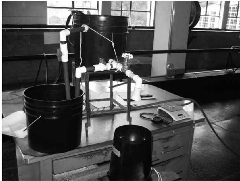
FIGURA 7. Instalación de calibración de pluviógrafos con suministro constante de caudal, a través de válvula de mariposa graduada.
