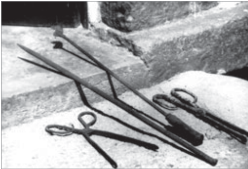
Dos tijeras de fragua, espetón y badil de la herrería de José M a Arruti, de Azpeitia.
