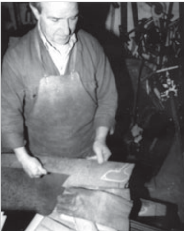
Peio Iríbar, de Villabona, preparando la plancha para la fabricación de un callo.
