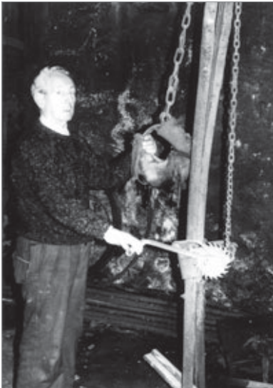
Torno de tensar la testuz donde se aprecia perfectamente su engranaje y trinqueta. Su propietario, José Bereciartúa de Lazkao, nos lo muestra.
