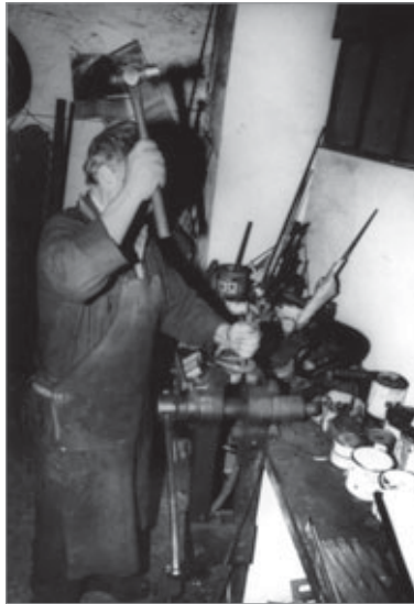
Peio Iríbar, de Villabona, terminando de perforar la clavera ya con la herradura en frío.
