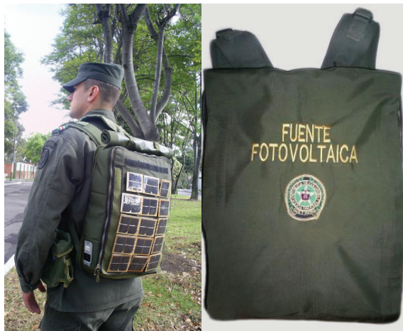
Fig. No. 1. Fuente Fotovoltaica Portátil Fase I
