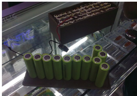
Fig. No. 7. Litio Ion modelo construcción de batería 4s8p
