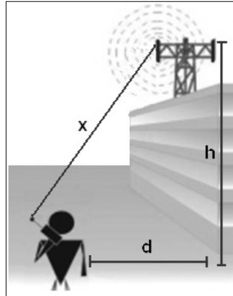
Figura 3. Diagrama de la BTS al móvil
