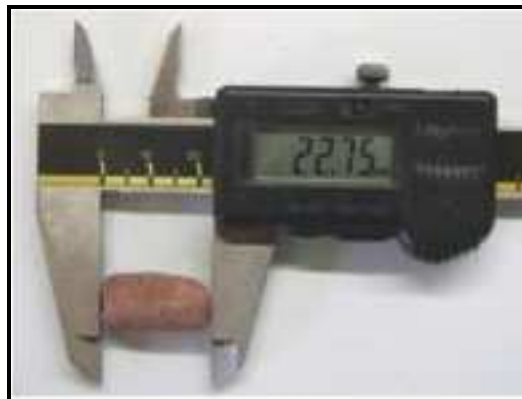
Figura 6: Bala cilíndrica, conocida como slugg.
