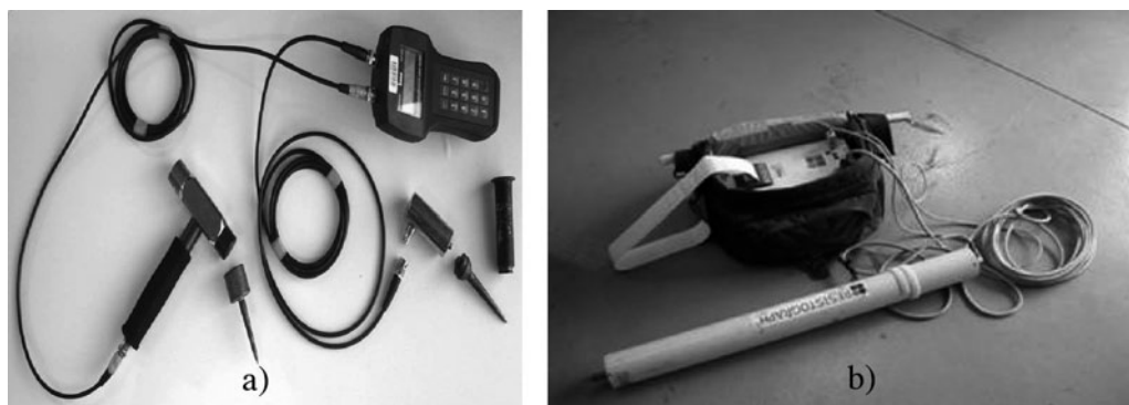
Figura 1. a) Martillo sónico IML utilizado para estimar la velocidad de transmisión de sonido sobre el árbol en pie. b) Resistógrafo, 3500 utilizado para estimar la resistencia a la penetración de una microaguja en dirección transversal a la madera
