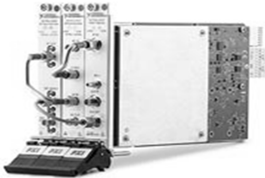
Fig. 14. Analizador de señales NI PXIe 5663 [25]
