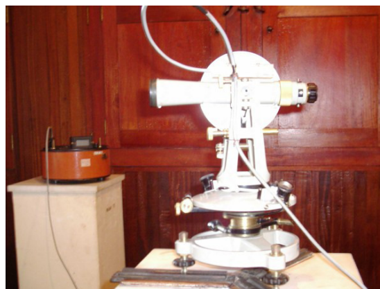
Figura 5. Imagen del magnetómetro Diflux utilizado por el Observatorio de Fúquene
