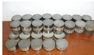
Figura 1 Probetas usadas en el estudio (der) y esquema de las posiciones usadas para la medición de dureza en la cara plana de las probetas (izq).
