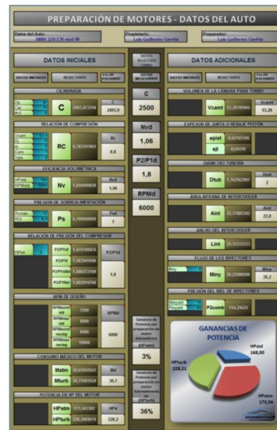
Figura 5. Datos ingresados para gasolina en el software de selección de turbocompresores.
