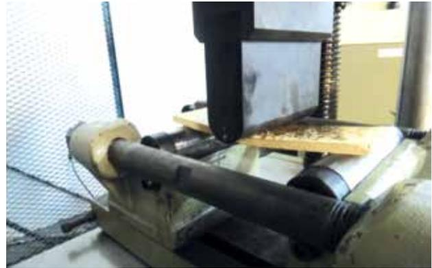
**Figura 3.** Prueba de flexión estática para tableros aglomerados.
